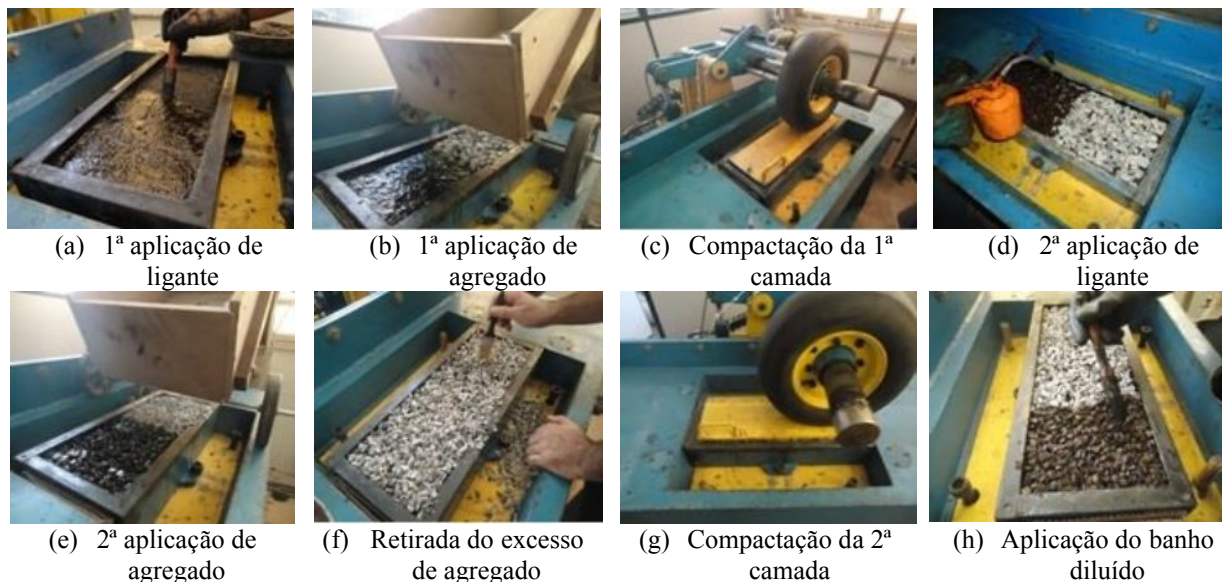
Figura 2: Etapas desenvolvidas na moldagem dos revestimentos TSD
