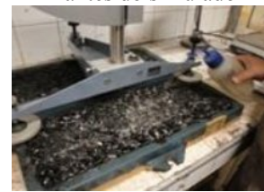
(h) Ensaio de pêndulo após o simulador
