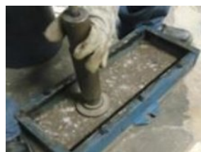
(a) Compactação da base de solo-brita
