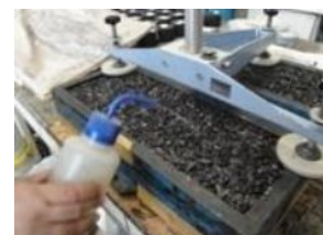
(d) Ensaio de pêndulo antes do simulador
