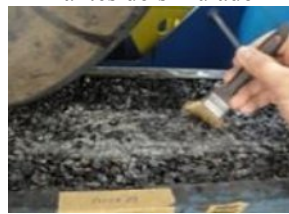
(g) Retirada do agregado solto
